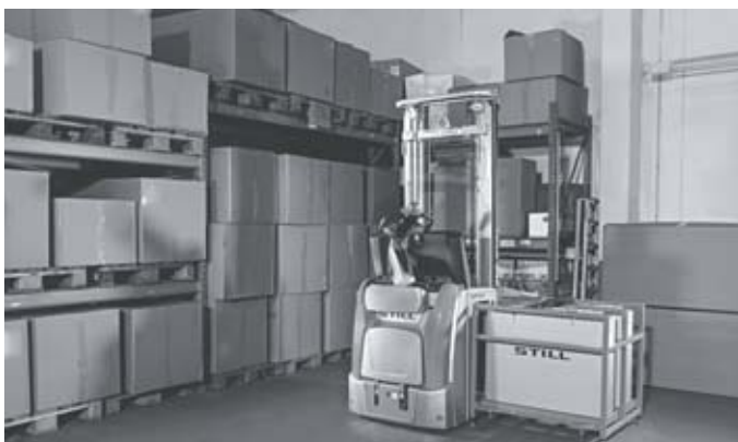
Altid klar til brug takket være mulighed for batteriskift ud gennem siden
