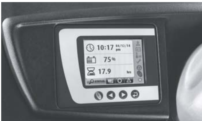
Altid overblik: Farvedisplay med mange sproguafhængige symboler viser alle de vigtige funktioner på én gang
