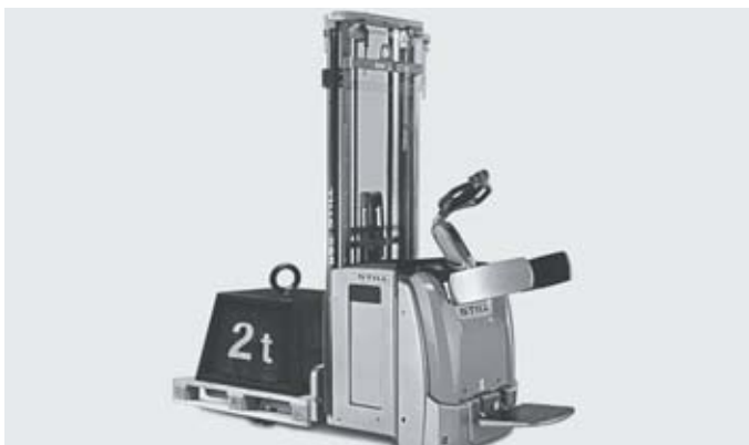
Maksimal kraft: Hvis der ikke er brug for mastløftet, kan der transporteres op til 2,0 t på initialløftet
