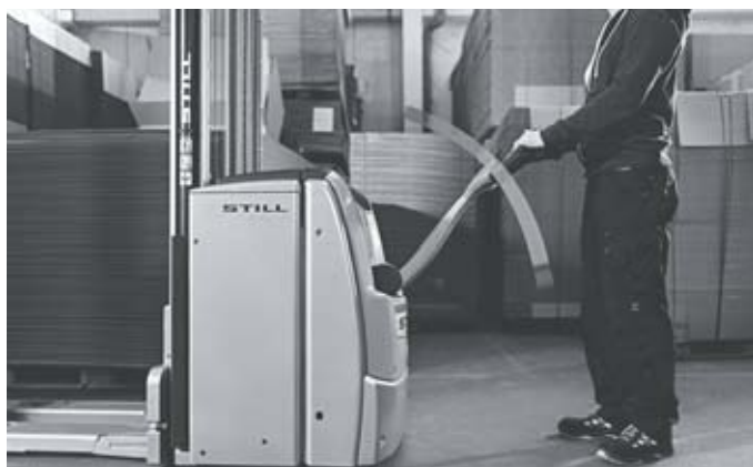
Sikkerhed som standard: Hastigheden tilpasses automatisk afhængig af afstanden mellem fører og stabler, dvs. efter vinklen på styrestangen
